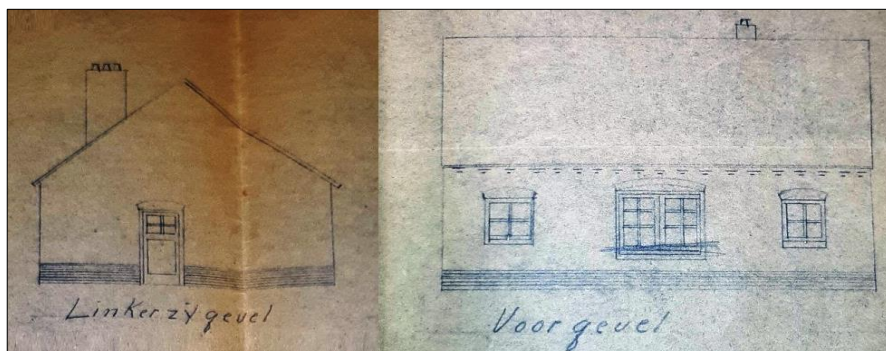
Foto 1: Detail van bouwtekening van woningwetwoningen in Horst uit 1947. Opvallend is dat het venster op bovenverdieping in de linkerzijgevel niet staat ingetekend, terwijl dit wel werd uitgevoerd. Bron: Gemeentearchief Horst.
